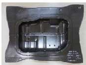
CFRTTP によるオイルパンのプレス成形
