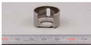
名称：ハウジング 材質：電磁ステンレス t1.2 特徴：オールプレス。中心バー リング部板厚均一
